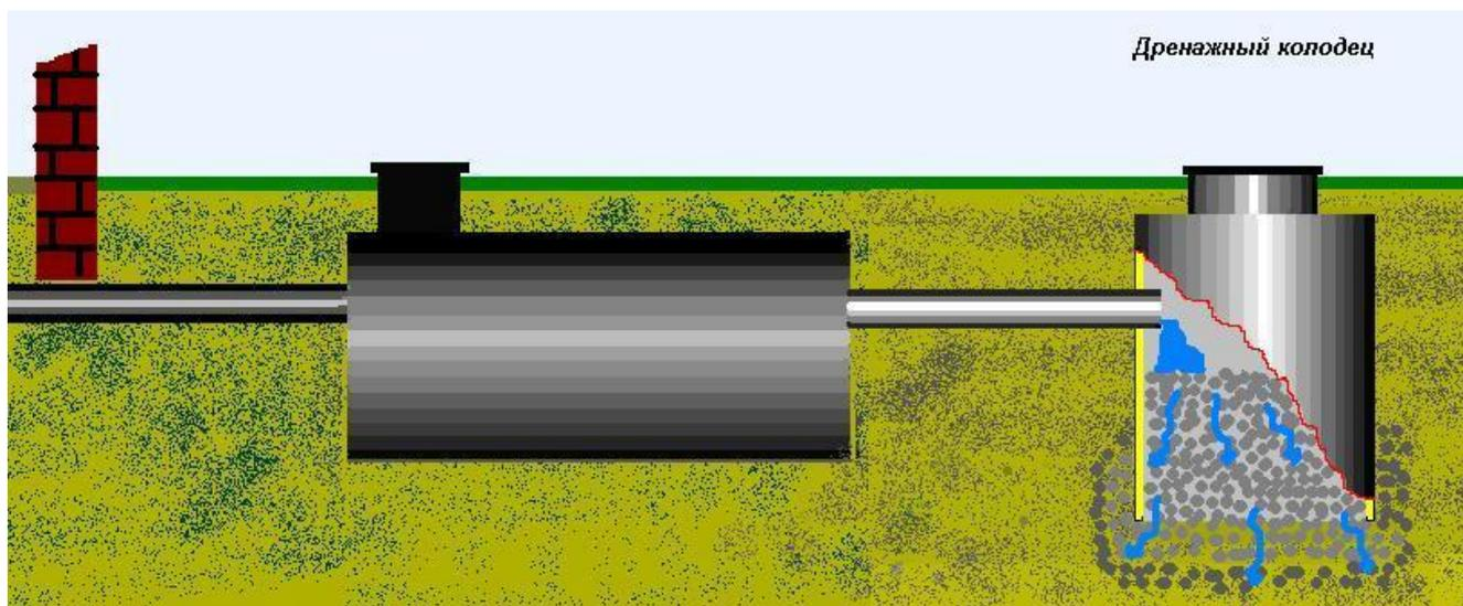
б) Отвод очищенной воды через перфорированную дренажную трубу самотеком:
