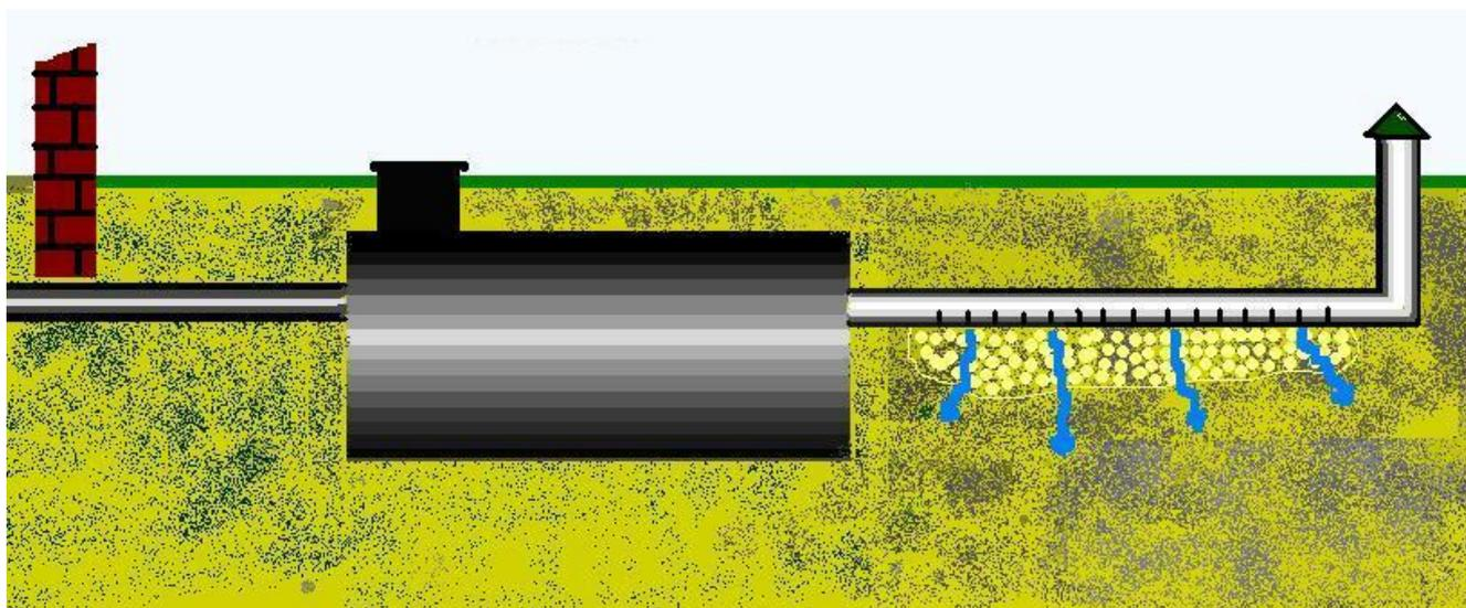
Длина дренажной трубы определяется исходя из коэффициента фильтрации грунта, производительности установки. Общая длина нити не должна превышать 25м. При необходимости укладывается несколько нитей в траншее min шириной 60см с
